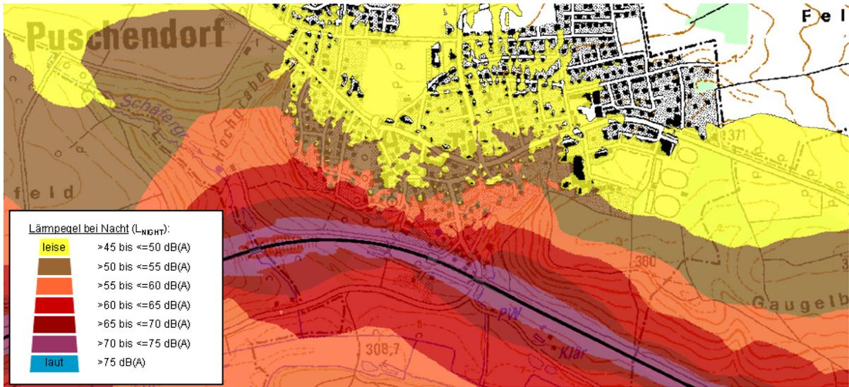
Abb 5: Schienenlärm 8-Stunden  $L_{\text{Night}}$  in dB(A)
