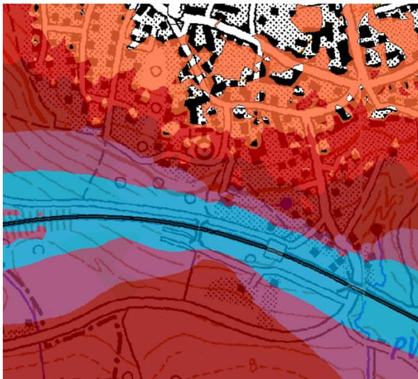
Abb. 6: Schienenlärm 24-Stunden  $L_{\text{DEN}}$  in dB(A)
