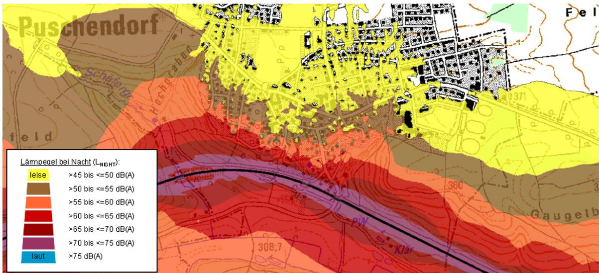
Schienenlärm 8-Stunden  $L_{Night}$  in dB(A)
