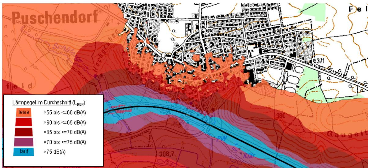
Abb. 4: Schienenlärm 24-Stunden  $L_{DEN}$  in dB(A)
