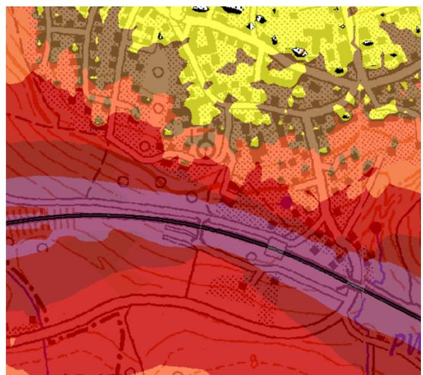
Abb. 7: Schienenlärm 8-Stunden  $L_{\text{Night}}$  in dB(A)
