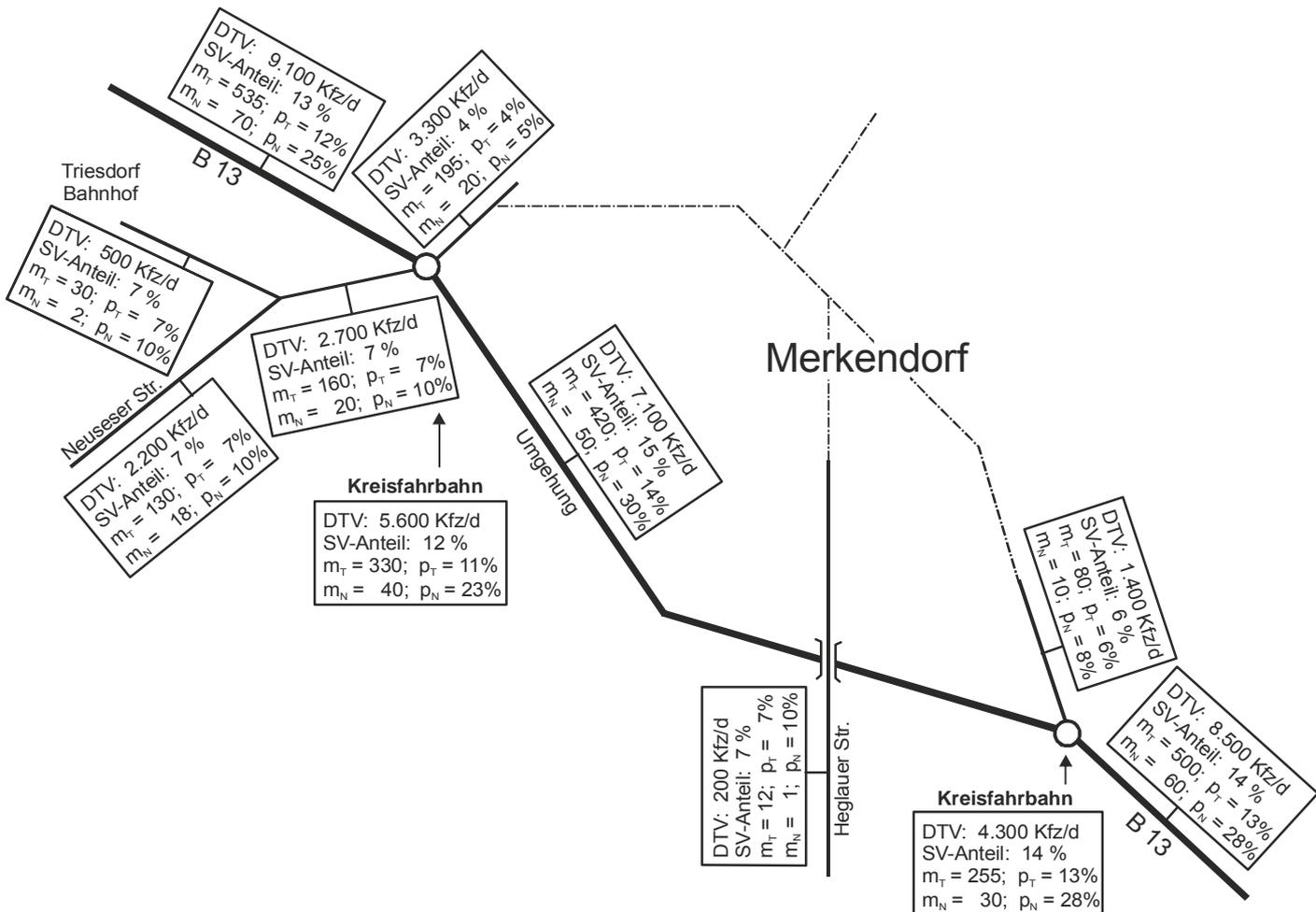
Abb. 3 : Kenngrößen für die Lärmberechnung nach RLS-90 (Lkw  $\geq 2,8$  to)
