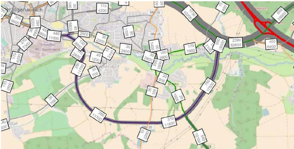
Abbildung 1: Verkehrsbelastungen Planfall 7 (2035) in DTWv Kfz/24h und SV/24h
