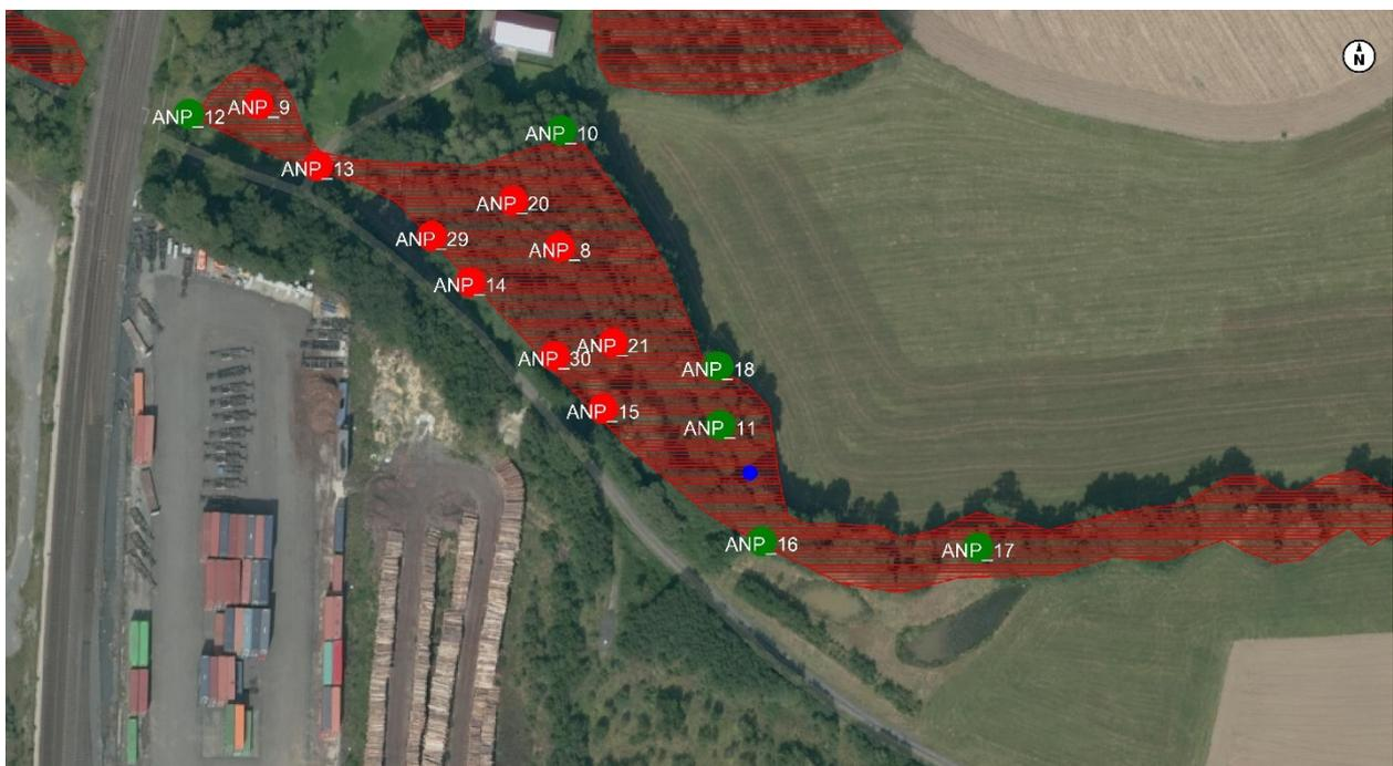
Abbildung 47: Analysepunkte (ANP) bzgl. NO<sub>x</sub>-Immissionen. Rot markiert: Überschreitung, grün markiert: Einhaltung des Irrelevanzkriteriums nach TA-Luft. Blau markiert: Einleitstelle.
